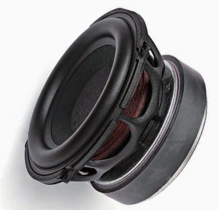
フェライト・マグネット磁気回路、5インチのロング・スロー・ボイスコイルをそなえたミッドウーファー。
