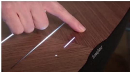
独自の「Senso™Technology」により、電源オン/オフ、音量コントロールなどあらゆる機能を、木製トップパネルのスリットに触れるだけで操作できます。また、OMNIAは、Bluetooth (aptX HD)、Apple AirPlay 2、Chromecastなど、今日主流のデジタルメディアに幅広く対応。スマートフォンやタブレットからお好みのストリーミング再生が手軽に楽しめます。
