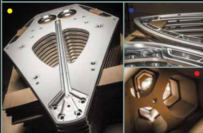
●組み立て前のデュアル・エンクロージャー ●底面に用いられ、デュアル・エンクロージャーの振動を拡散・吸収するT.M.D. ●上面用のT.M.D. ●ウーファー・エンクロージャー内部の補強枠と、上面・底面のメタル・パーツを結ぶ「アニマ・レガータ」用の孔
