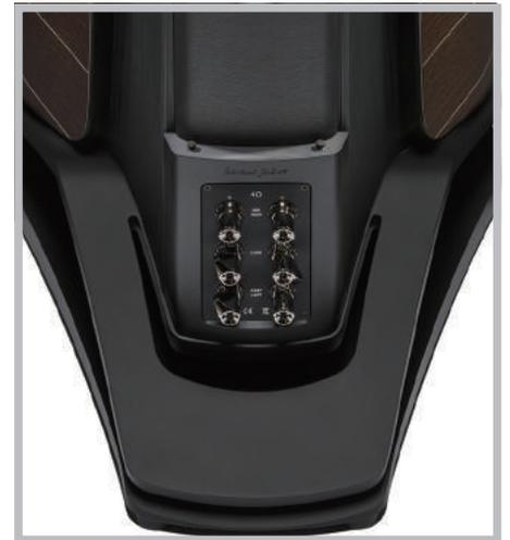
リアバッフル最下部の入力ターミナルは、バナナプラグにも対応するトライワイヤリング方式。パワーアンプ(ステレオ)1台での駆動だけでなく、別のパワーアンプでスーパーウーファーを駆動するバイアンプ方式、ミッドレンジ+ツイーター、ウーファー、スーパーウーファーをそれぞれに別個のパワーアンプで駆動するトライアンプ方式など多様なシステム・アップが可能です。
