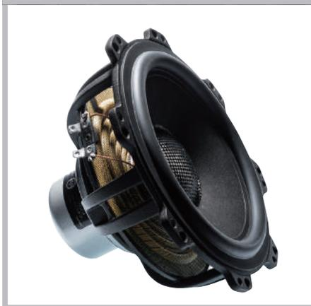
アイダIIは、さらに55Hz以下の超低域再生を担う320mm口径スーパーウーファーも備えています。中空粒子配合のコア材をナノカーボン・シートで挟み込むサンドイッチ構造コーンにより高い剛性を獲得、ソナス・ファベール史上最大とも言える4インチ口径のロングスロー・ボイスコイルを備えたネオジム磁気回路によって、高速でダイナミズムに富んだ堂々たるパフォーマンスを実現します。“ZVT”とボトムプレート間に下向きで設置、ドライバー・ユニットのエネルギーをより効率的に引き出せるようチェンバー構造も一新しており、深く伸びながら360度に広がるナチュラルな低域の力感を満喫していただけます。
