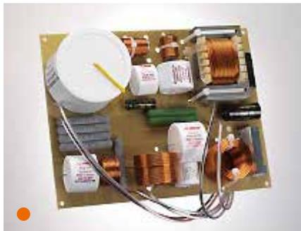
試聴を繰り返して厳選されており、ドイツ ムンドルフ社の「EVO」最新世代キャパシター、ジャンセン社製インダクターなど、オーディオ用の最高級品を使用しています。
