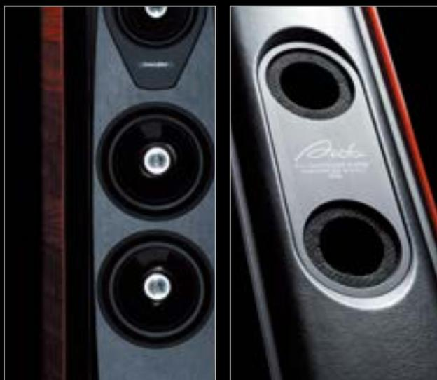
中音域ドライバー・ユニットは 180mm 口径で、ネオジウム・マグネットと 1.7 インチ・ヴォイスコイルによる強力な駆動回路をそなえ、CNC 加工された航空機用金属と砲金を組み合わせることにより振動要素の相殺を図ったシャーシにマウントされています。ダイアフラムは、自然な空気乾燥を経て形成された非圧縮パルプをベースにパピルス/セルローズ・パルプを加え、さらにカボックやケナフなどの軽量の素材を絶妙にブレンドすることで自然な音質を実現。表面を粘弾性素材でコーティングすることで、コーンの色づけを抑えており、スピーカー・システムの表現力を左右する中音域を、やわらかくあたたかく再現します。また、チェンバー共振や歪みを排除するために、ダイアフラム中央に同軸フェーズ・プラグを設けました。
