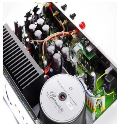
051インテグレートド・アンプは他のブルメスター製品と同様にコンピューター測定による厳重なパーツのペアリング、300項目に及ぶリファレンス・モジュールとの比較テスト、実負荷による1週間のバーン・イン、その後、さらに同じチェックを繰り返し、最初のテスト結果と一致するものだけが最終的にヒアリング・テストを経て出荷されます。
